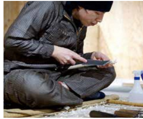
専用の刃物・サルキリを材料となる木に当て、手作業で繊細な彫りを施す笹野一刃彫。常に大怪我のリスクと隣り合わせでもある。
