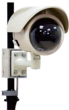
設置した簡易型河川監視カメラ
