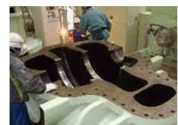
県営事業で対応したポンプの補修
