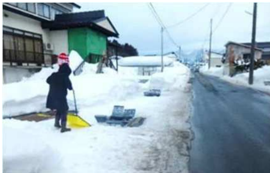
消流雪用水としても利用されている農業用水路（新庄市）
