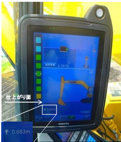
【ICT建機のバックホウのモニタ画面】画面に施工目標と自機の状態表示を行っている。
