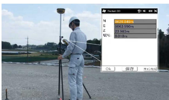
①GNSSローバーによる座標計測 (計測時間 約10秒/1点)
