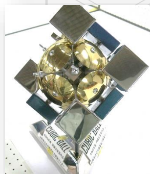
キューブ組立 材質：SUS304,t1.5mm (TIG溶接・仕上げ・塗装)
