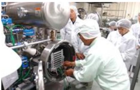
熱水貯湯式レトルト殺菌機を使つての試作
