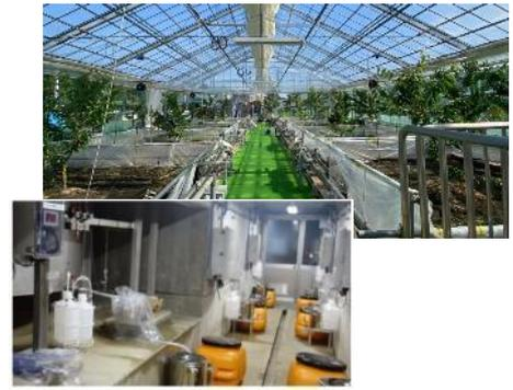
ライシメータ（土壤溶液採取装置）
