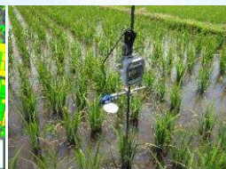
葉面濡れセンサーによるいもち病の発生予測
