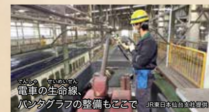
電車の生命線、パンタグラフの整備もここで JR東日本仙台支社提供
