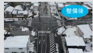
▲交差点の全方向に右折レーンを設置
