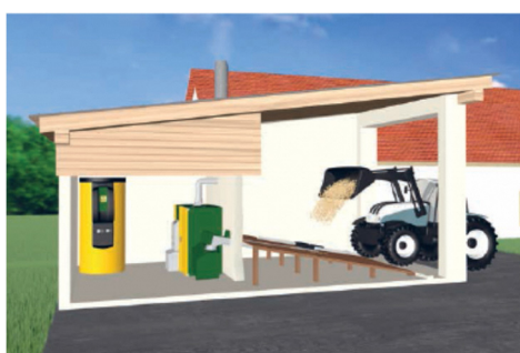
図表 79 燃料投入方法別の平置き式と地下式イメージ
