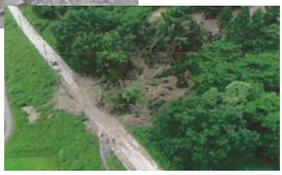
山腹崩壊と幹線用水路埋塞（飯豊町高峰）
