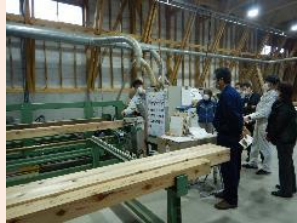
人工乾燥材の製材状況
