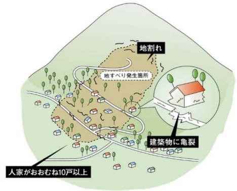
緊急調査のイメージ(地すべり)
