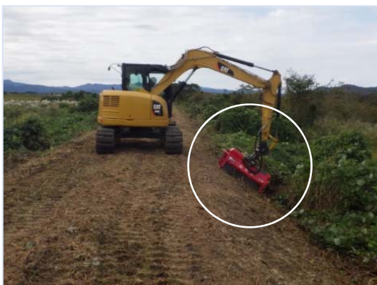
草刈り装置を取り付けたバックホウによる堤防除草作業
