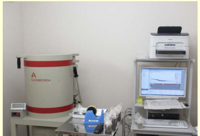
～導入されたゲルマニウム半導体検出器～ =放射性物質の種類と放射能を測る=
