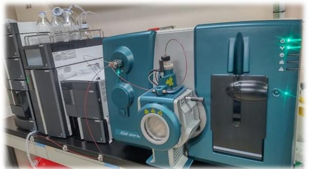
液体クロマトグラフ/タンデム質量分析装置（LC/MS/MS）
