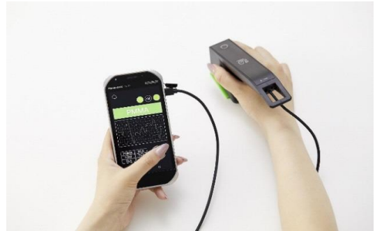
ぶらしる（プラスチック材質判別装置）
