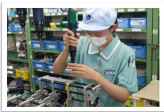
1台を1人で組上げるセル方式なので1台くらいですね。ラインによる組立だと大人数で組み付けるので大量に作れるのですが、私の部署は人数も多くないので、1日で2~3台を完成させています。
