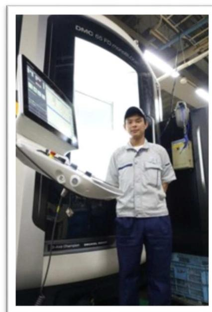
開発中の新製品の、試作品の加工をしています。具体的にいうと、ブロックの状態のアルミを、同時5軸加工機を使って削り出す加工をしています。その際、CAMという専用ソフトを使用して、加工するためのプログラムも作ります。
